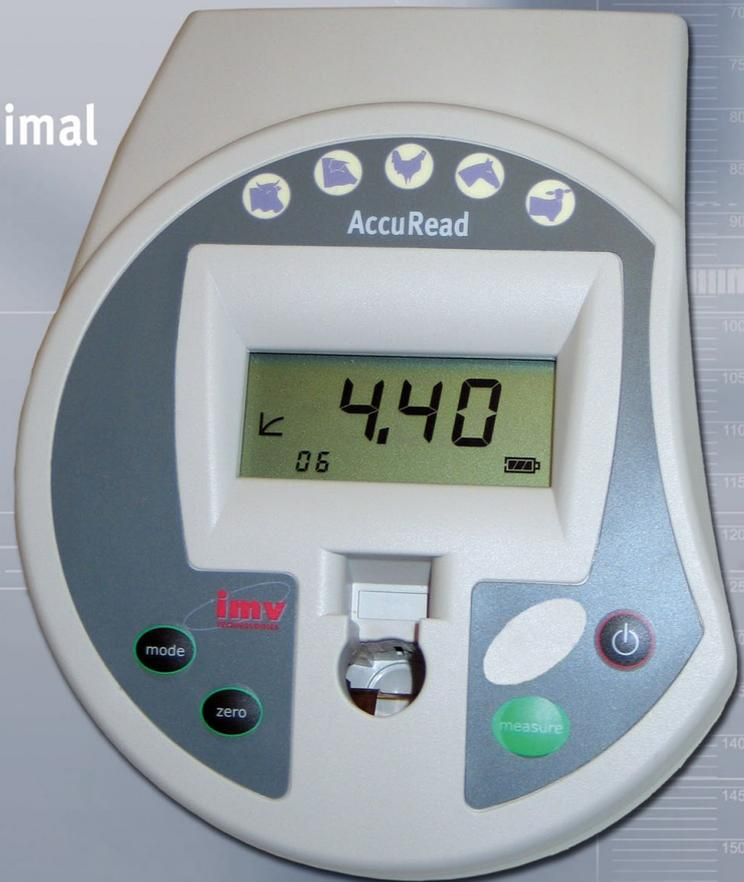
Este fotómetro, transportable y de volumen reducido, puede funcionar tanto con corriente eléctrica de red como con batería. Lectura directa de la concentración gracias a un diodo emisor de luz (LED) combinado con una fibra óptica (ausencia de filtros, mayor precisión). El fotómetro Accuread da el resultado tanto en absorbancia como en concentración. Por otro lado, tiene una salida RS 232 para comunicación a PC o impresora.
